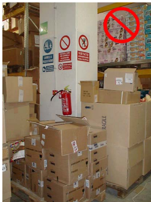
Disposizione scorretta dei materiali
